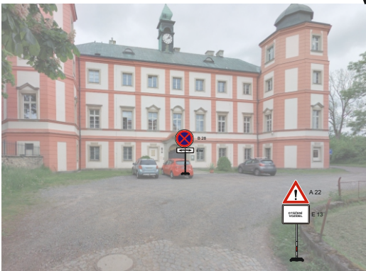
Vymístění vozidel - osazení DZ 7 dní před plánovanými pracemi.
